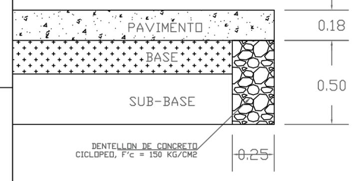
DETALLE DE DENTELLON DE CONCRETO CICLOPEO EN BOCACALLE
