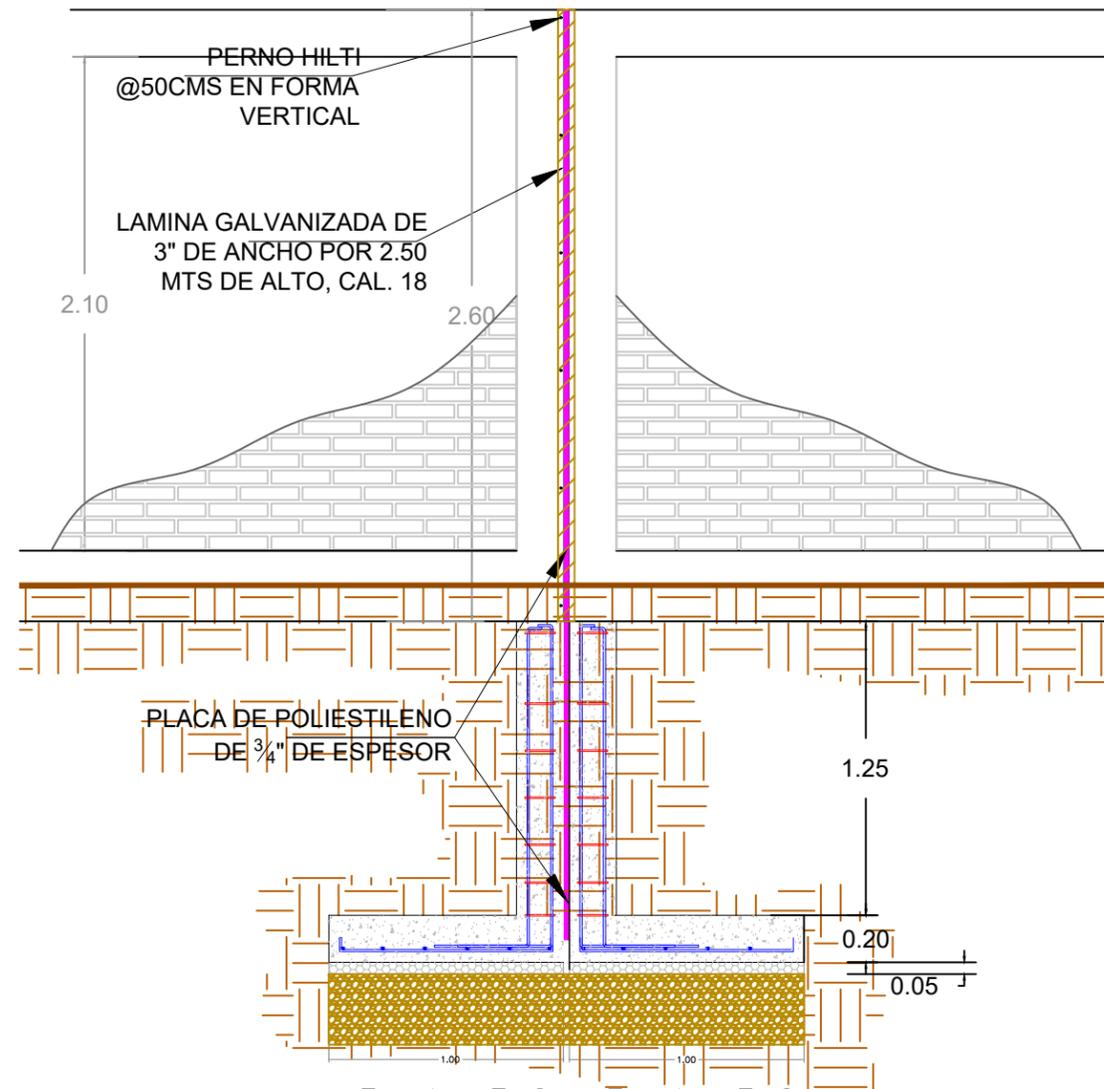
DETALLE DE JUNTA DE CONSTRUCCION VISTA FRONTAL
