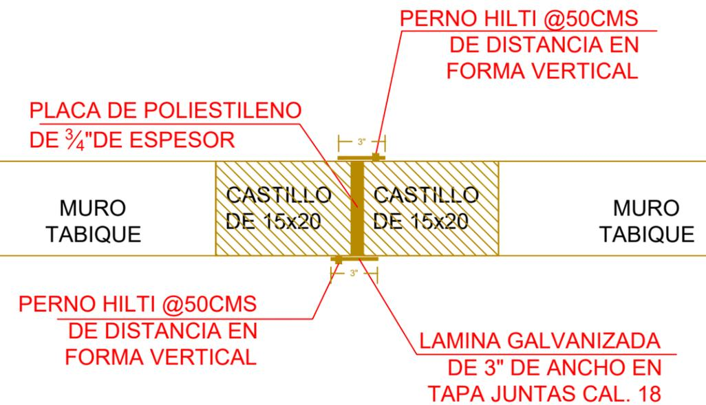
DETALLE DE JUNTA DE CONSTRUCCION VISTA EN PLANTA
