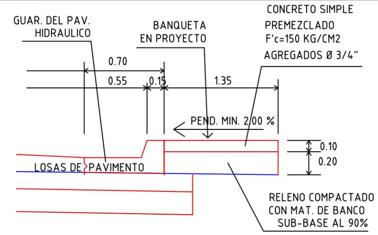
CORTE EN SECCION "B"
