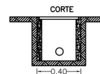
PAREDES DE CONCRETO DE F'c=150 KG/CM2
