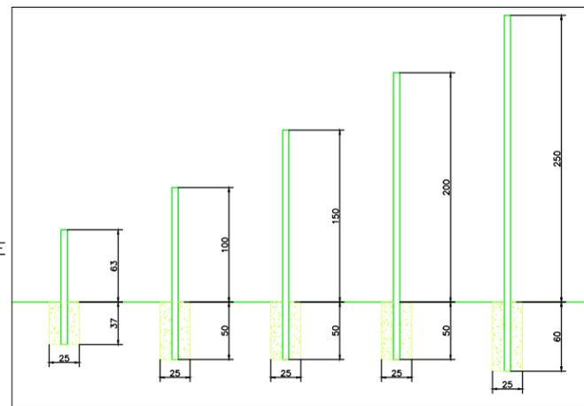
DETALLE DE CIMENTACIÓN DE POSTES SEGÚN ALTURA DE POSTE ESCALA 1:25
