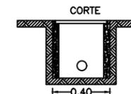
PAREDES DE CONCRETO DE F'C=150 KG/CM2
