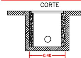
PAREDES DE CONCRETO DE F'C=150 KG/CM2
