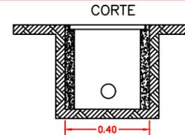
PAREDES DE CONCRETO DE F'C=150 KG/CM2
