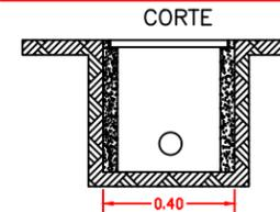
PAREDES DE CONCRETO DE F'C=150 KG/CM2
