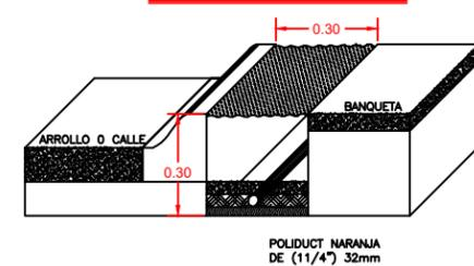
PAREDES DE CONCRETO DE F'C=150 KG/CM2
