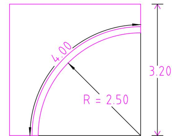
DETALLE DE GUARNICIÓN EN APROCHES (LLEGADAS A CALLES CON PAVIMENTO)
