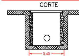
PAREDES DE CONCRETO DE F'C=150 KG/CM2
