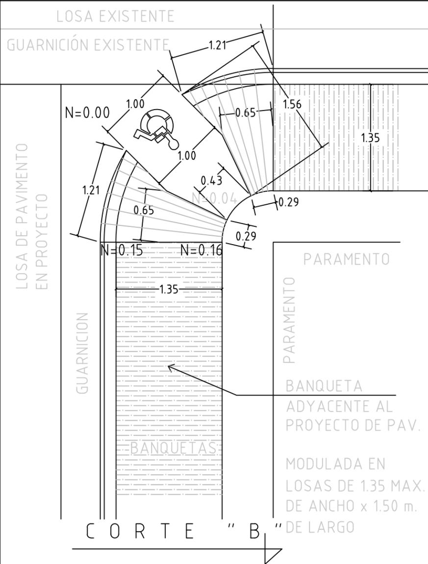
VISTA EN PLANTA DEL DETALLE PARA ACCESO EN BANQUETAS SIN ESCALA
