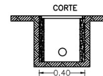
PAREDES DE CONCRETO DE F'C=150 KG/CM2
