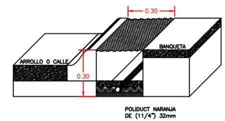
PAREDES DE CONCRETO DE F'C=150 KG/CM2
