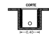
PAREDES DE CONCRETO DE F'C=150 KG/CM2
