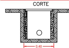
PAREDES DE CONCRETO DE F'C=150 KG/CM2
