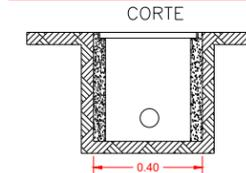
PAREDES DE CONCRETO DE F'C=150 KG/CM2
