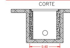
PAREDES DE CONCRETO DE F'C=150 KG/CM2
