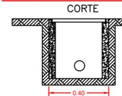
PAREDES DE CONCRETO DE F'C=150 KG/CM2
