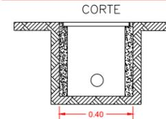
PAREDES DE CONCRETO DE F'C=150 KG/CM2
