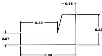
DETALLE DE GUARNICION (TIPO "L") ASFALTO
